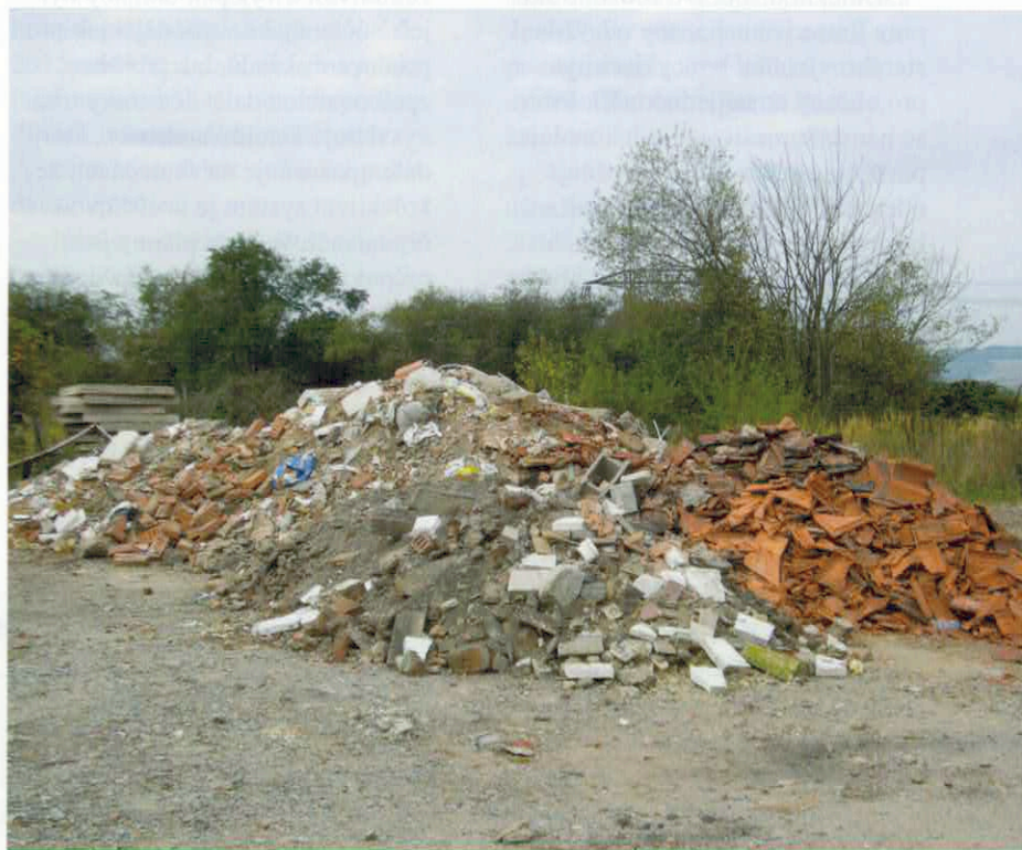
Stavební odpad může být po roztřídění využit jako kvalitní surovina
